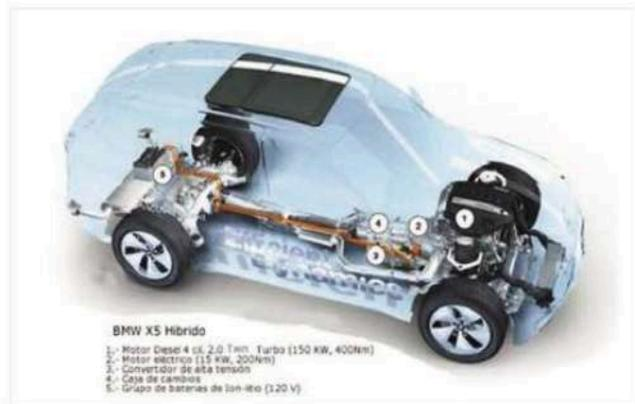
Figure 2. Partes de un automóvil híbrido[4]
