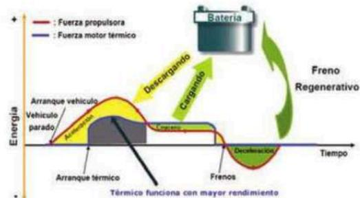
Figure 1. Ciclo de funcionamiento del vehículo híbrido[2]
