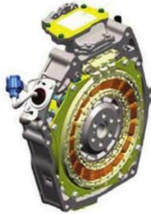
Figure 21. Motor/generador IMA de Honda Civic.[12]
