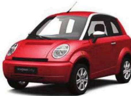
La batería del THINK City está ubicada en la zona inferior del habitáculo, debajo de los asientos. El motor está delante, junto con el resto de los elementos mecánicos. La tracción es delantera.
