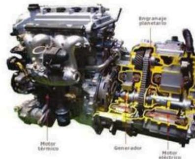
Figure 4. Motor térmico y eléctrico y generador eléctrico Toyota Prius[6]
