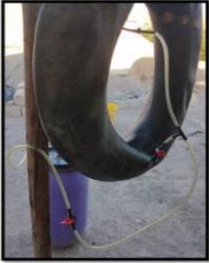
Figura 6. Biodigestor construido
