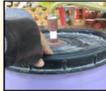
Figura 3. Salida del biogas
