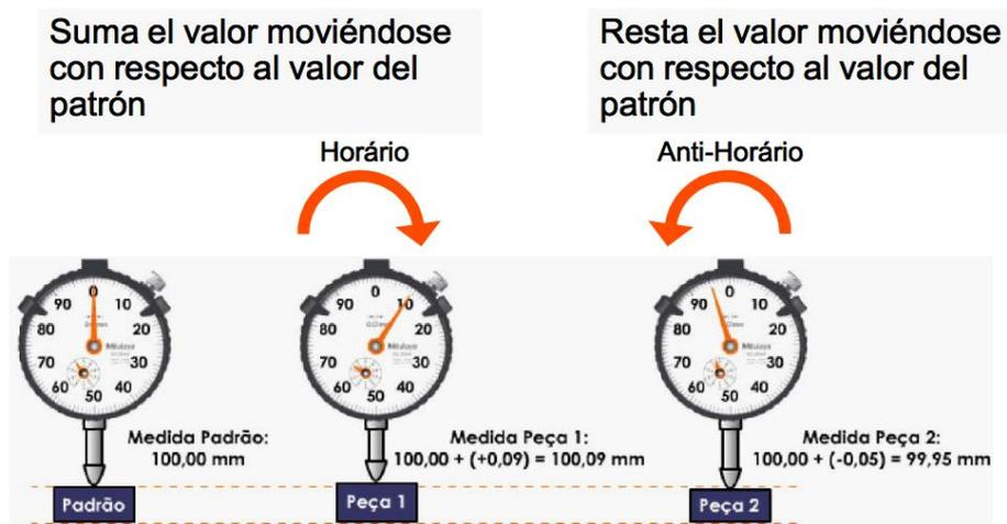
Fig. 18. Medición y comparación[9]
