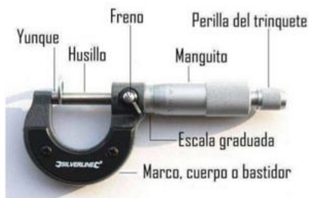
*Fig. 9. Micrómetro[6]*
